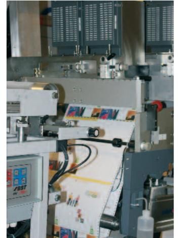
nisse entsprechend ändern. Der gegenüber den bisherigen Modellen verkürzte Papierweg soll für weniger Bahnrisse und eine höhere Produktivität sorgen. Durch die »Single-Engine-Duplexdruck«-Konstruktion erfordern die neuen Modelle eine um 40% geringere Stellfläche als vergleichbare Systeme.
